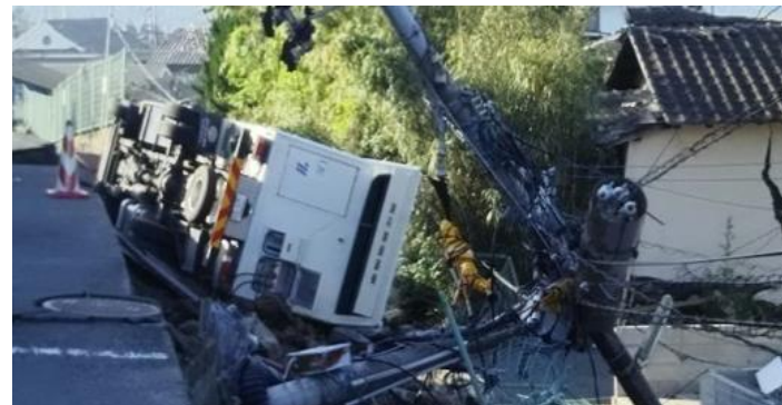
電源車の横転で電源喪失 (九州電力)
