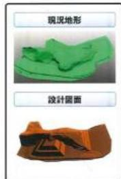
3次元測量データ(現況地形)と設計図面との差分から、施工量(切り土、盛り土量)を自動算出。
