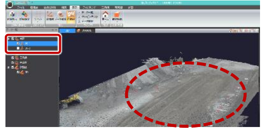
起工測量時の点群データ
